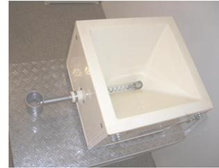
**Volumetrisches Dosiergerät HETHON-FLEX HF51**
