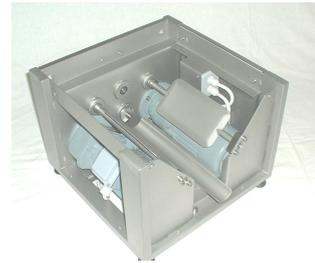
Auswechselbare Dosierwerkzeuge erlauben die optimale Anpassung an Dosierleistung und Schüttgewicht.
